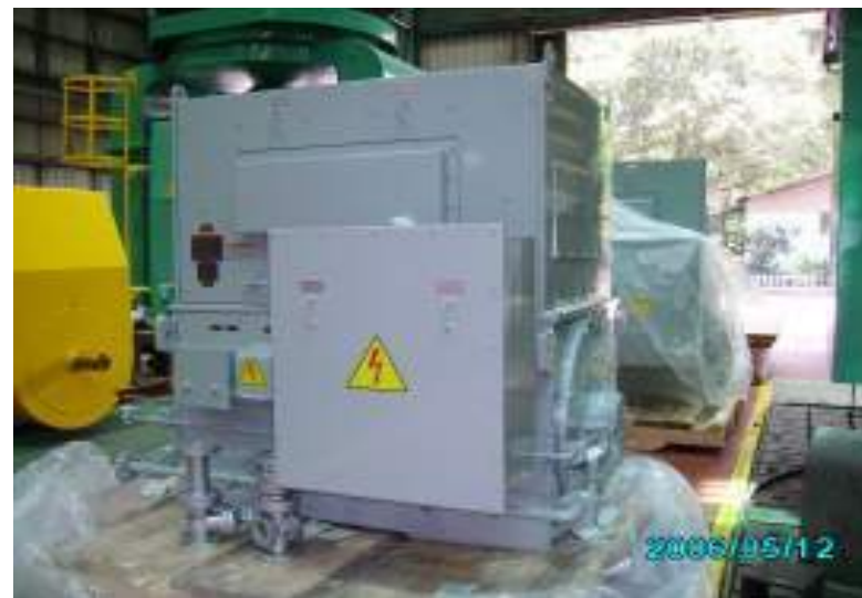
2050kW 2P 4kV 60Hz TEWAC Motor
